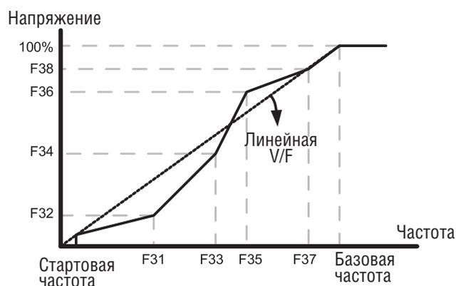
● Регулировка выходного напряжения
