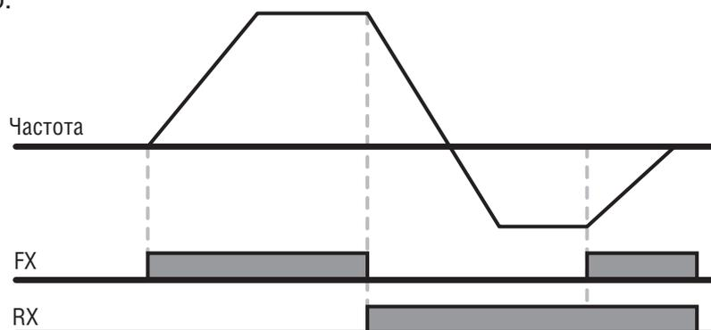
● Поддача команд с помощью клемм FX, RX, вариант 2
