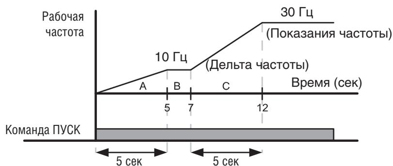
● Установка времени разгона/торможения при помощи многофункциональных клемм
