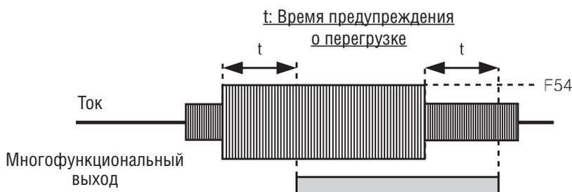
● Сбой из-за перегрузки
