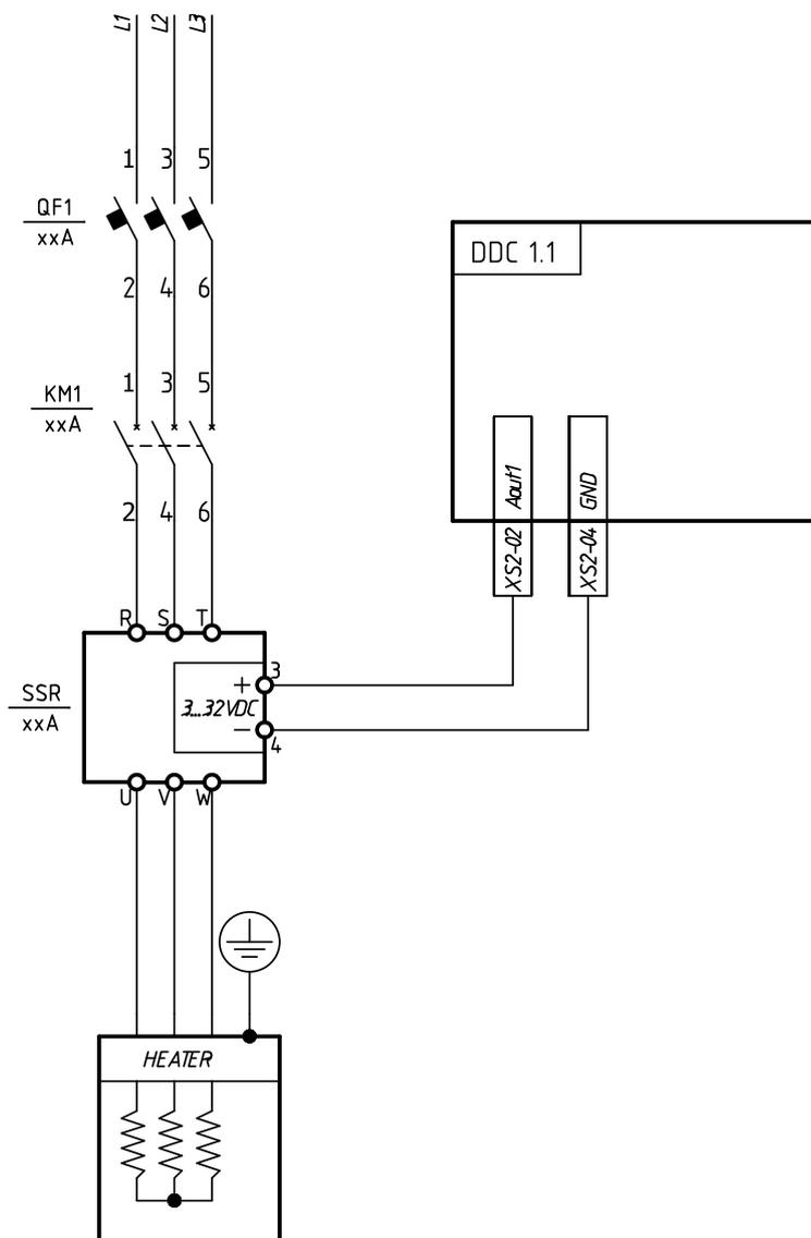
Выходы Aout1 и Aout2 могут быть настроены как для работы в режиме ШИМ, так и в пропорциональном режиме. Настройки каждого выхода независимые.
