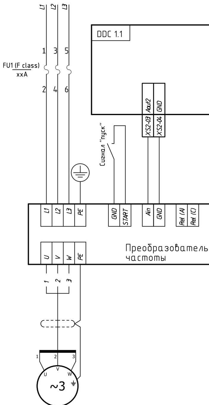
**Подключение преобразователя частоты.**
