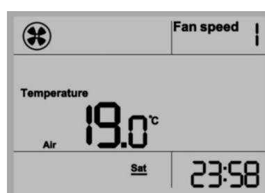
Вид индикатора после кратковременного нажатия кнопки «Fan». Режим вентиляции без подогрева воздуха. Отображение температуры в канале воздуховода.
