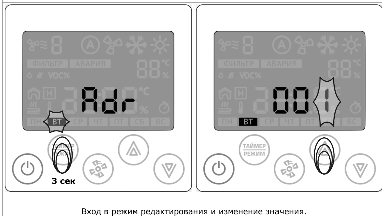
Вид системного меню и метод выбора необходимого параметра.
